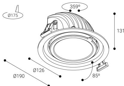
Instalación: Mantener una distancia mínima de seguridad de 50 mm entre el equipo y el techo para garantizar su correcto funcionamiento.
