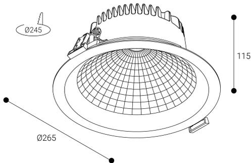
Instalación: Mantener una distancia mínima de seguridad de 50 mm entre el equipo y el techo para garantizar su correcto funcionamiento.
