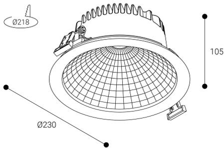
Instalación: Mantener una distancia mínima de seguridad de 50 mm entre el equipo y el techo para garantizar su correcto funcionamiento.
