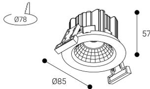
Instalación: Mantener una distancia mínima de seguridad de 50 mm entre el equipo y el techo para garantizar su correcto funcionamiento.
