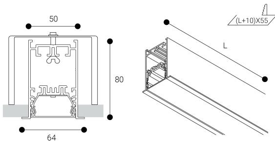
Instalación: Mantener una distancia mínima de seguridad de 50 mm entre el equipo y el techo para garantizar su correcto funcionamiento.
