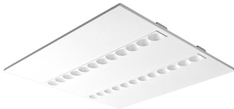
Pantallas iluminación LED: Nassel Avant .Reflector de muy baja luminancia, fabricado en policarbonato de alta reflexión. Cuerpo construido en chapa de acero galvanizado lacado con resinas poliéster de alto rendimiento mediante aplicación electrostática . Difusor: Lente de policarbonato. Distribución luminosa: Directa. Acabado: Blanco.
