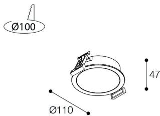
Instalación: Mantener una distancia mínima de seguridad de 50 mm entre el equipo y el techo para garantizar su correcto funcionamiento.
