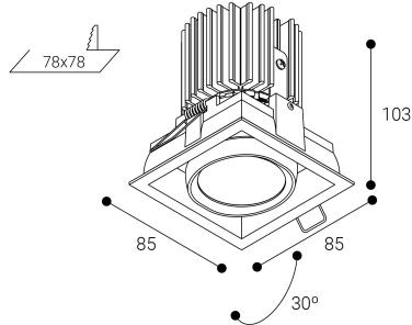
Instalación: Mantener una distancia mínima de seguridad de 50 mm entre el equipo y el techo para garantizar su correcto funcionamiento.
