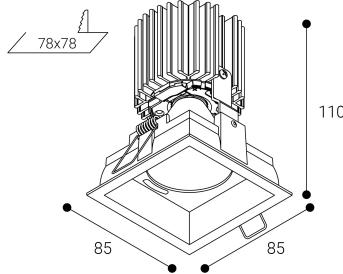
Instalación: Mantener una distancia mínima de seguridad de 50 mm entre el equipo y el techo para garantizar su correcto funcionamiento.
