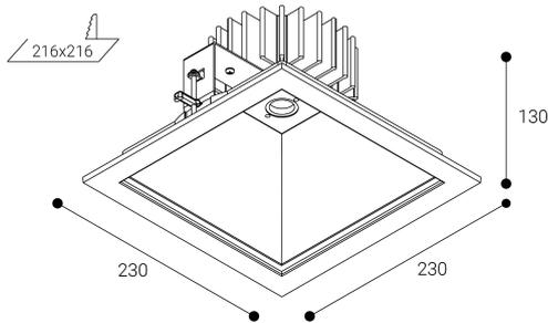
Instalación: Mantener una distancia mínima de seguridad de 50 mm entre el equipo y el techo para garantizar su correcto funcionamiento.
