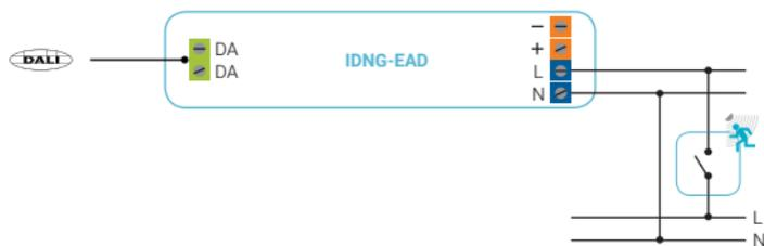
Conexión de un regulador de luz
