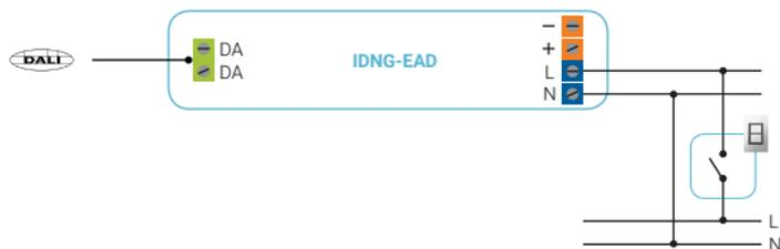
Conexión de un detector de presencia
