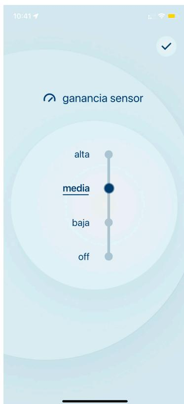
**Ganancia sensor.** Aquí podremos configurar el nivel de sensibilidad del sensor de luminosidad. La ganancia del sensor será OFF por defecto.
